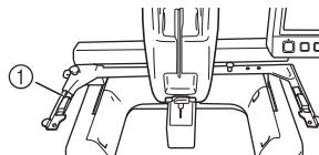
① Soporte del bastidor de bordado C (con protectores de esquinas de color gris oscuro)
