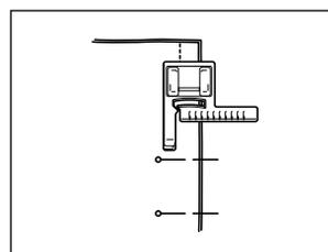
Quando si usa uno spillo per marcare, rimuoverlo sempre prima del piedino per allineamento punti verticale.
