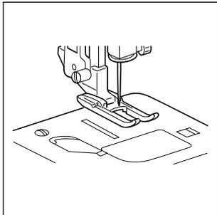
Coloque el prensatelas en el portaprensatelas.
