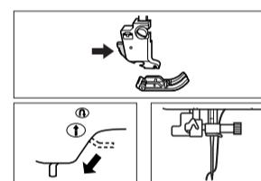
**Precaución:** La leva de enhebrar no se podrá utilizar después de colocar la cuchilla lateral. Si utiliza la leva de enhebrar podrá dañar la máquina al colocar la cuchilla lateral. Cuando enhebre de nuevo, asegúrese de hacerlo después de quitar la cuchilla lateral.
