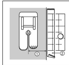
Bij het naaien met een rand breder dan 8.5 mm ① kan het handig zijn om een stukje tape op de naaldplaat ② te bevestigen dat u helpt bij het leiden van de stof.
