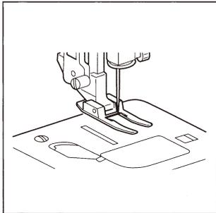
Coloque el prensatelas en el portaprensatelas.
