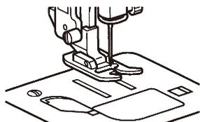
1 Cambie el prensatelas existente por el prensatelas antiadherente.
